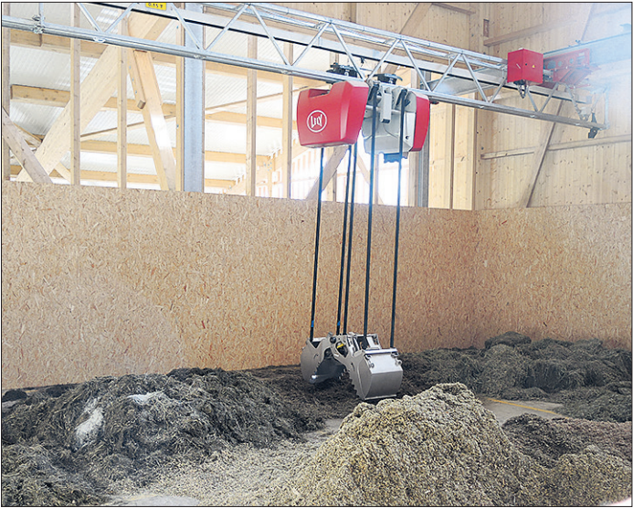
So läuft die vollautomatische, computergesteuerte Fütterung und Entmistung: Der Kran (links) sammelt die Futterkomponenten zusammen, wirft sie durch eine Öffnung im Boden direkt in den Futtermischwagen (Mitte), welcher das Futter auf die Tiere verteilt. Stündlich macht der Entmister (rechts) seine Runde durch alle Laufgänge. Fotos Josef Stirnimann-Maurer
