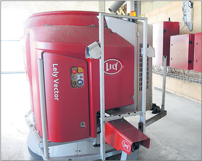
So läuft die vollautomatische, computergesteuerte Fütterung und Entmistung: Der Kran (links) sammelt die Futterkomponenten zusammen, wirft sie durch eine Öffnung im Boden direkt in den Futtermischwagen (Mitte), welcher das Futter auf die Tiere verteilt. Stündlich macht der Entmister (rechts) seine Runde durch alle Laufgänge. Fotos Josef Stirnimann-Maurer
