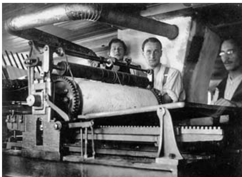
Für den Druck des Anzeigers vom Rottal diente jahrelang eine Schnellpresse mit Benzinmotorantrieb und Handanlage.
